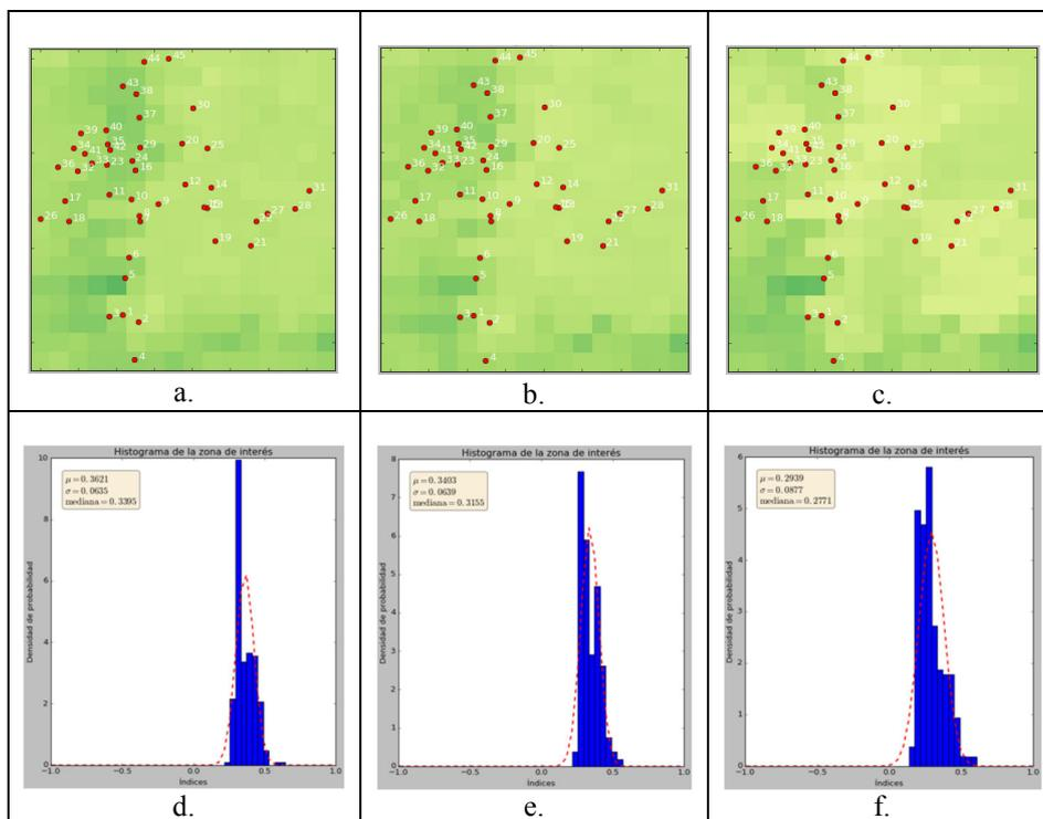
**Fig. 5.** Deterioro del NDVI por la presencia de un Evento de Incendio, mediante ilustración de las imágenes Ráster (a., b. y c.) e histogramas (d., e. y f.). (a. y d.) Día 28-07-2016. (b. y e.) Día 13-08-2016. (c. y f.) Día 29-08-2016
