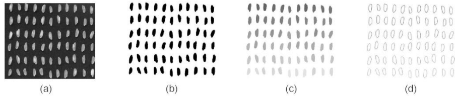
Fig. 1. Imagen (a) original, (b) Binarizada (c) Con granos identificados por niveles de gris (d) De los contornos de los granos
